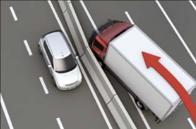
Auslenkung bei flexiblem Betonsystem: 1,3m
