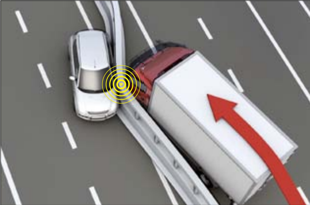
Auslenkung bei flexiblem Betonsystem: 1,3m
